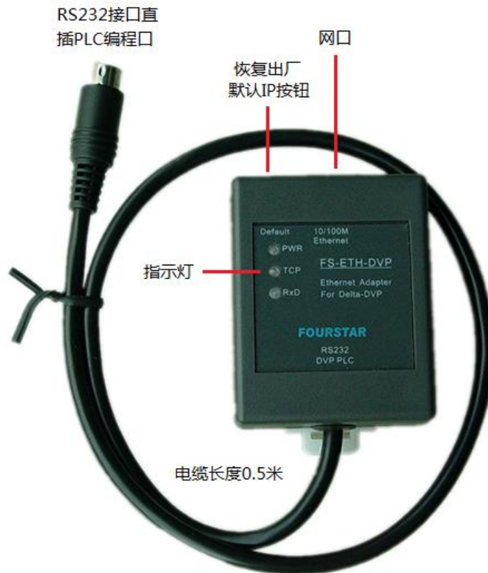
图3-1 FS-ETH-DVP的外部结构及各部件说明
