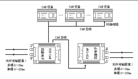
用两个背靠背的 FIB-CAN 可组成光纤中继器,光纤传输距离延长一倍
